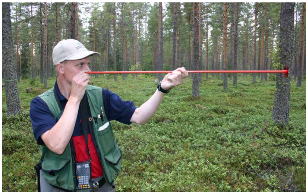
Metsäsuunnittelija Pekka Kanninen arvioi metsäkuvion puustoa relaskoopilla 2000-luvun alkuvuosina. Kuva: Raili Hokajärvi.
